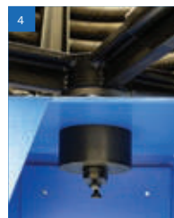
REEL ROLLER MECHANICAL BRAKE FRENO MECCANICO SBOBINATORE
